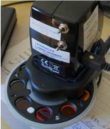
Une roue de 8 filtres (495, 550, 570, 610, 665, 695, 760 et 780 nm) qui permet une analyse très étendue en dehors du champ visible.
